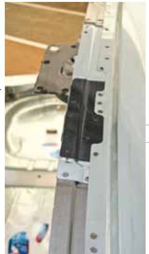
Die Modellvariante des Grand C-Max mit Panoramadach zeigt hier wie das warmumgeformte Verstärkungsblech in der Dachstruktur eingebunden ist
