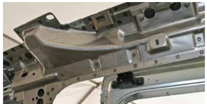
Fest verankert in der Dachstruktur der Karosserie sind auch die oberen Blechkassetten für die Führung der hinteren Schiebetüren
