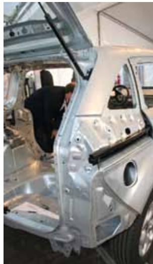
Diese Heckansicht zeigt die tiefe Ladekante, den großen Heckklappen-ausschnitt und die Führungsschiene der Schiebetür am Ford C-Max
