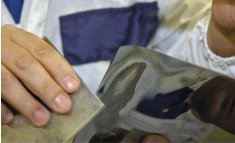
Der transparente UV-Spachtel härtet innerhalb von zwei bis drei Minuten aus.
