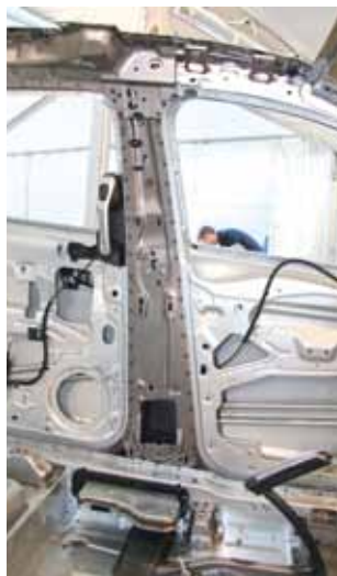
Im Karosserierohbau ist das große, warmumgeformte Verstärkungsblech in der B-Säule gut zu erkennen
