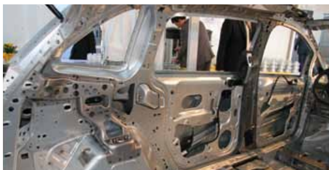
Der Blick von hinten in den Innenraum zeigt die dunkleren Verstärkungsbleche am Radhaus zur Seitenwand
