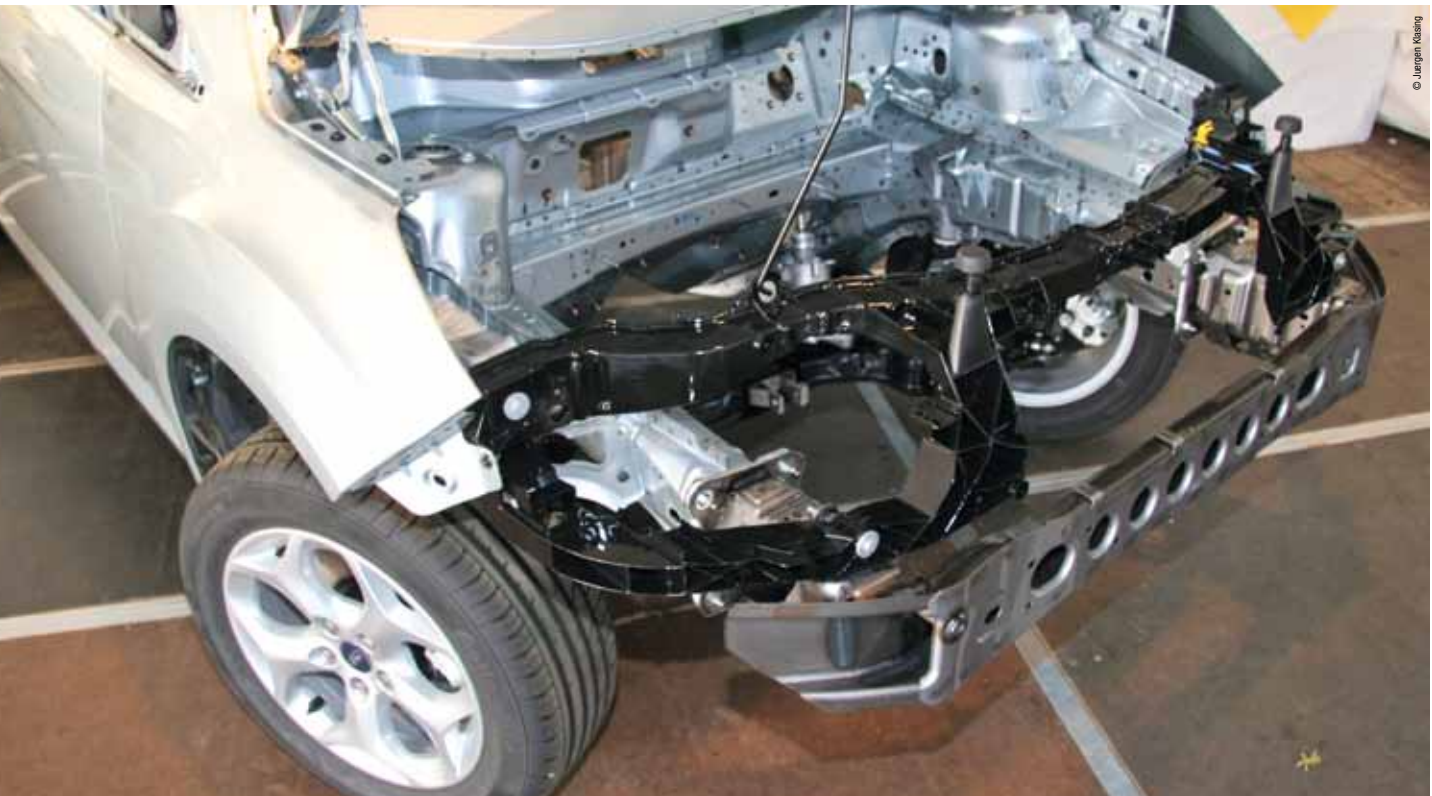
Im Vorderwagen wird die Schraubtechnik eingesetzt, um den Frontend-Träger (schwarz), den Stoßfängerquerträger, die Kotflügel und die Crashboxen an den Längsträgern zu fixieren
