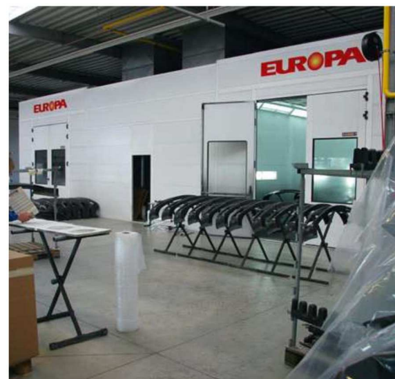
Bei der Industrielackierung werden die zahlreichen Serienteile einzeln mit der Hand nachgeschliffen, um die gewünschte Oberflächenqualität zu erreichen
