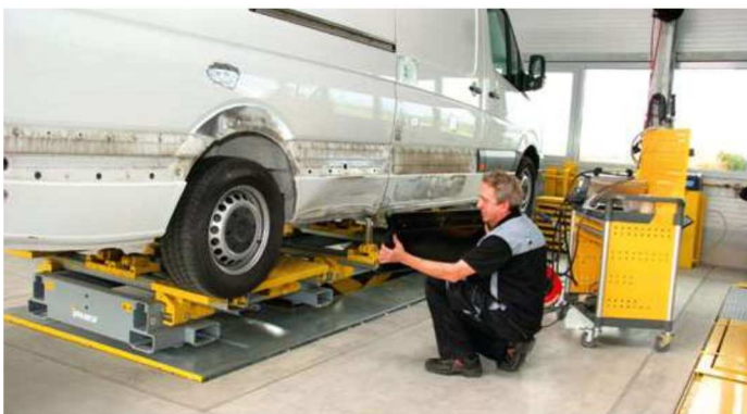
An der langen Spanesie-Richtbank mit Hebebühne kann Karosseriebauer Ewald Prassel optimal die Karosserie instandsetzen und neue Blechteile einschweißen
