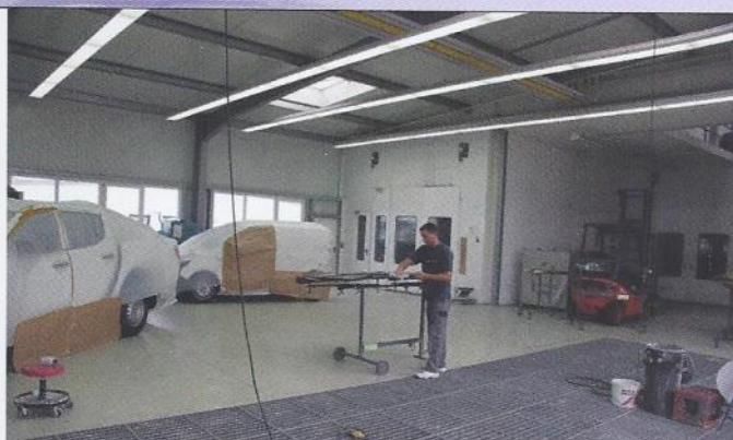
Die große Finishzone am Ende der Lackierstraße in Weißenburg (Tore links) lässt erahnen, welchen Platzbedarf Fahrzeuge und Teileständer bei vollem Durchsatz benötigen. Die rechten Kabinentore gehören zur Industrieteilekabine, diese ist zwei Meter breiter und länger, um viele Teile aufnehmen zu können
