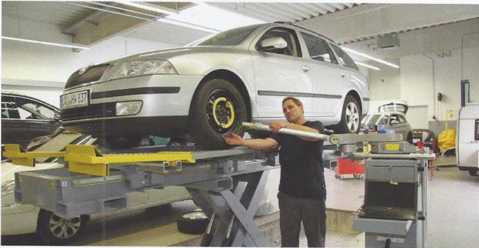
Modernste Ausrüstung bei der Unfallinstandsetzung: Spanesi-Richtbanksystem 106 und das Messsystem Touch werden von Thomas Skrodt regelmäßig eingesetzt
