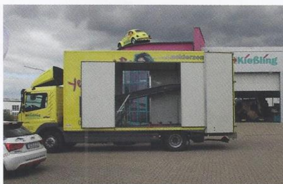
Der Transport-Lkw kann mit seiner Doppelstockbeladung und einem Anhänger drei Fahrzeuge gleichzeitig zwischen den Standorten verschieben. Auffällig: der Käfer auf dem Firmendach in Weißenburg
