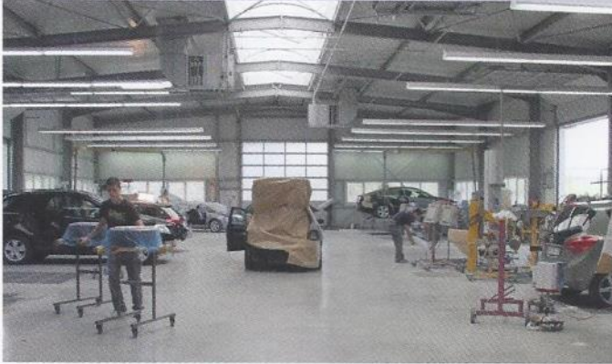
In der Weißenburger Vorbereitungshalle können an 16 Arbeitsplätzen mit Hebebühnen und Bodenabsaugung die Flächen an Fahrzeugen, Stoßfängerüberzügen oder Türen für die Lackierung geschliffen und gespachtelt werden
