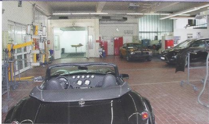
Die Lackierhalle Gunzenhausen im Überblick: Links das Tor zur BMW-Karosserieabteilung, im Hintergrund die Lackierkabine, im Vordergrund die Vorbereitungsplätze. Von der rechten Seite kommen Fahrzeuge von anderen Auftraggebern in das Lackierzentrum
