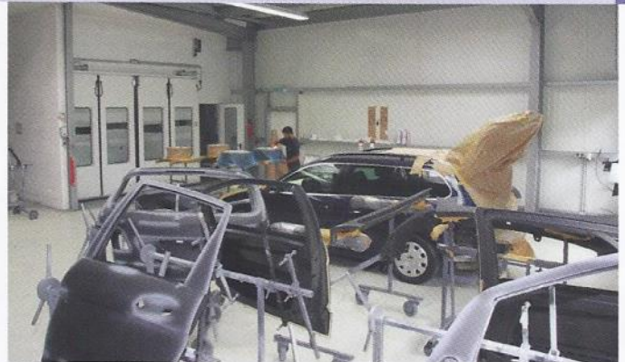
Nur staubfreie und abgedeckte Teile stehen in der Reinraumzone vor der 55 m langen Lackierstraße in Weißenburg. Nach der Basislack-Spritzkabine ist eine 2,5-fache Trockenkabine und anschließend eine Klarlack-Spritzkabine angeordnet
