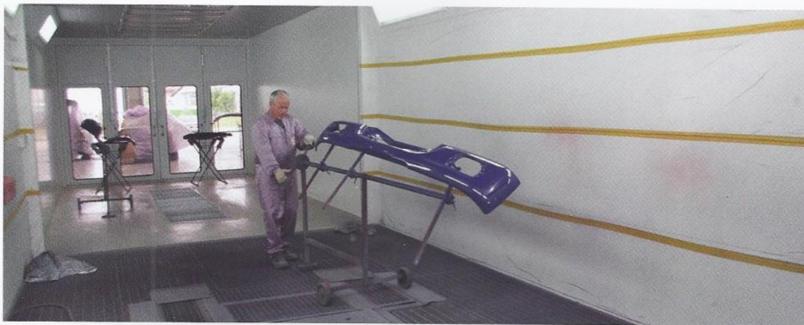
Blick in die Spritz- und die Trockenbox, die durch das Jalousietor verbunden und getrennt werden können
