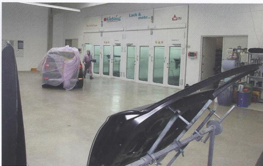
Im „Reinraum“ vor den beiden Kombikabinen können fertig vorbereitete Teile und Fahrzeuge in beliebiger Reihenfolge sortiert und gepuffert werden
