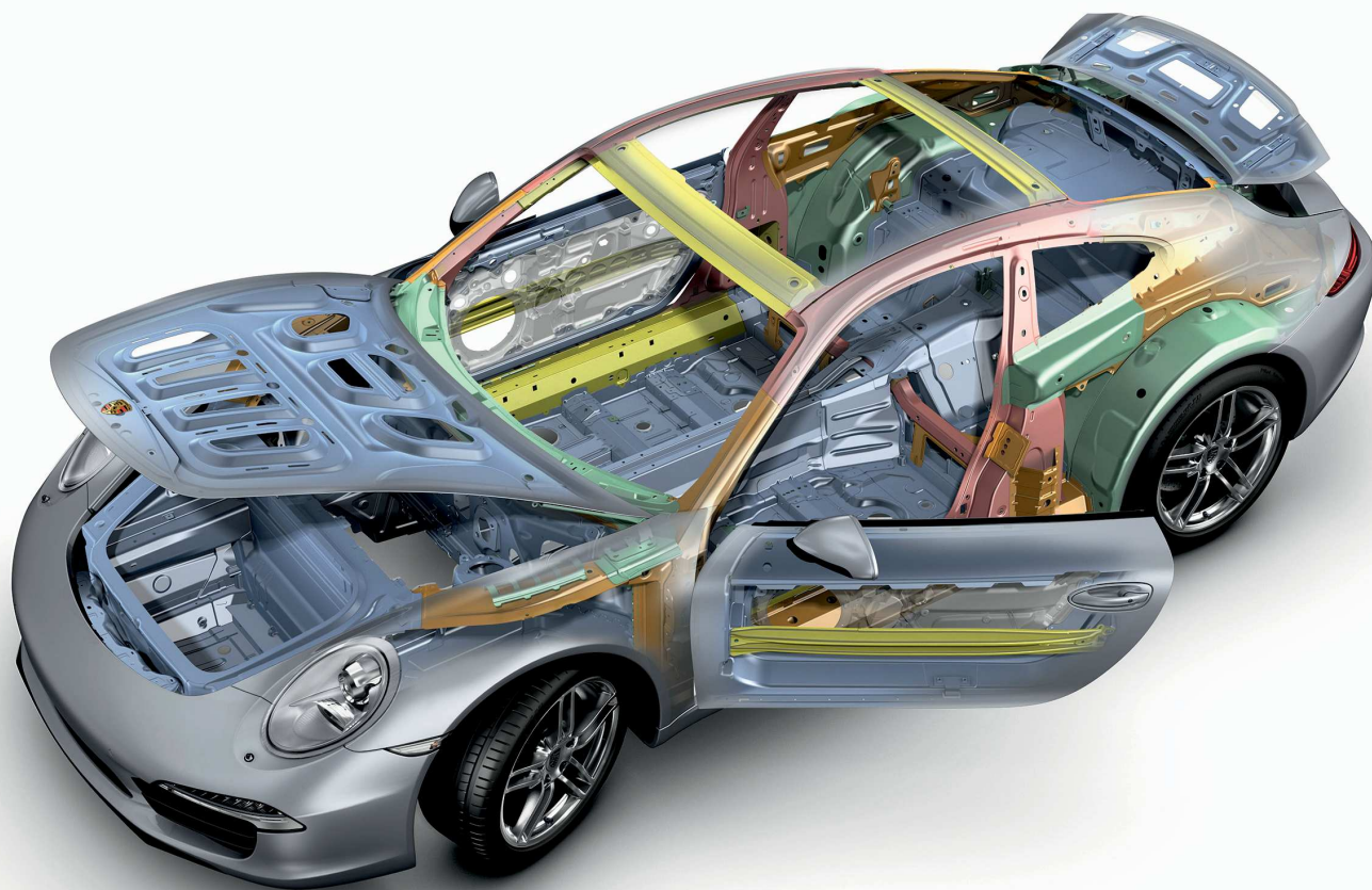
Moderner Karosseriebau in Aluminium-Stahl-Mischbauweise hier beim Porsche 911 Carrera
