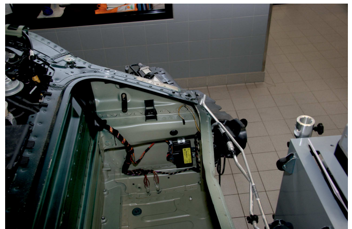
Frontschaden mit verbogenen Längsträgern vorne?
