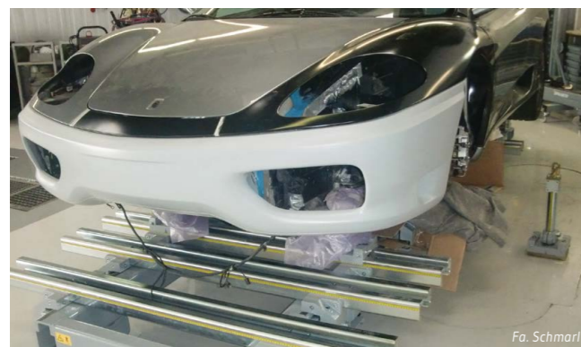
Vor der Reparaturlackierung werden alle Anbauteile montiert, um die Passgenauigkeit und die Spaltmasse zu kontrollieren.
