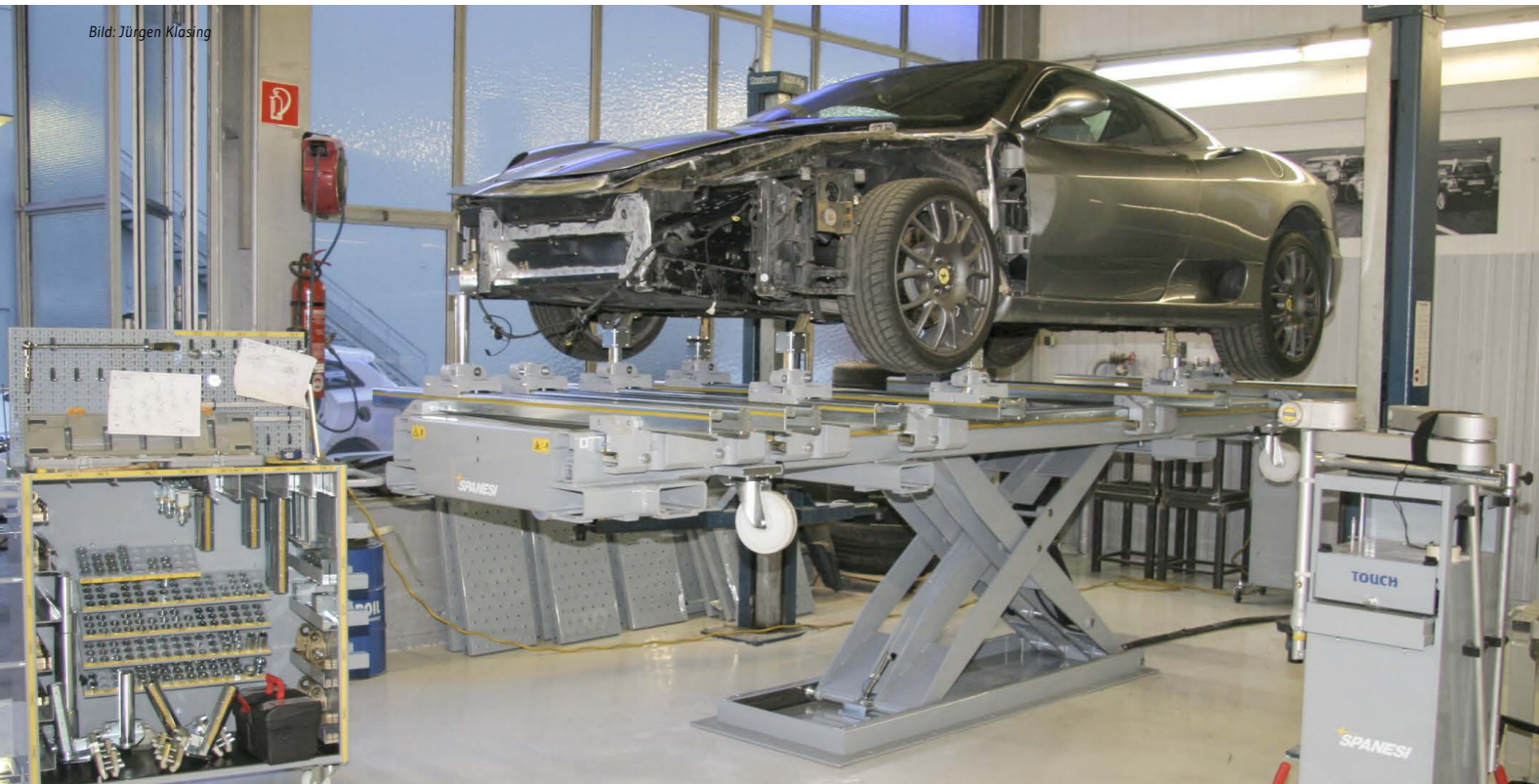
Investitionen für die Zukunft: das Karosserie-Messsystem Spanesi „Touch“ (rechts) und das Richtsystem Spanesi 106 mit 5 Meter Länge.
