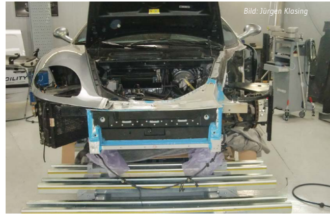
Die Karosseriestruktur ist wieder komplett instandgesetzt und die Befestigungspunkte für den Kotflügel, sowie das Frontend sind passgenau ausgerichtet.
